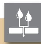
Versickerung durch die Fuge Abflussbeiwert C=0,1
