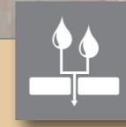
Versickerung durch die Fuge Abflussbeiwert C=0,1
