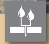
Versickerung durch die Fuge Abflussbeiwert C=0,3
