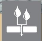
Versickerung durch die Fuge Abflussbeiwert C=0
